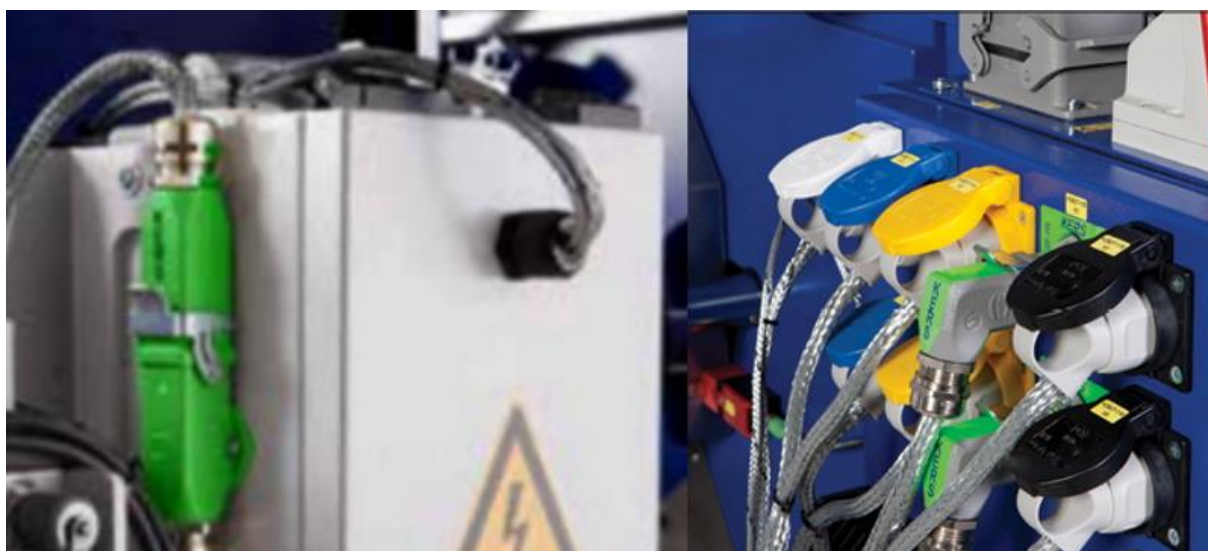
Anslutningar för KERS energiåtervinning på WITTMANN BATTENFELD formsprutor.
